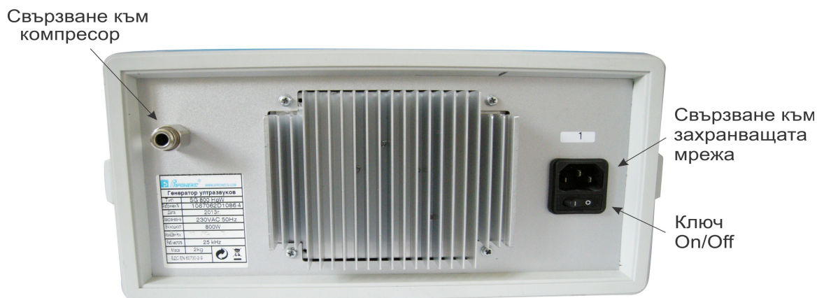
Фиг. 2.1b. Свързване на ултразвуковия генератор към захранващата мрежа и компресор за охлаждане на излъчвателя.
