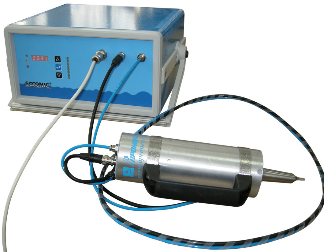
Фиг. 2.1а. Свързване на ултразвуковия генератор и излъчвателя.
